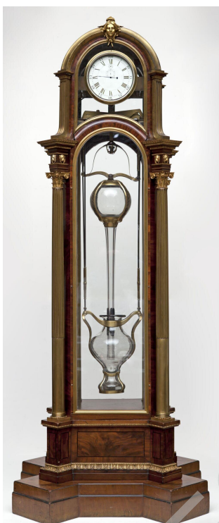
5. ábra. Az eredeti Cox-féle óra 2 (higany nélkül)
